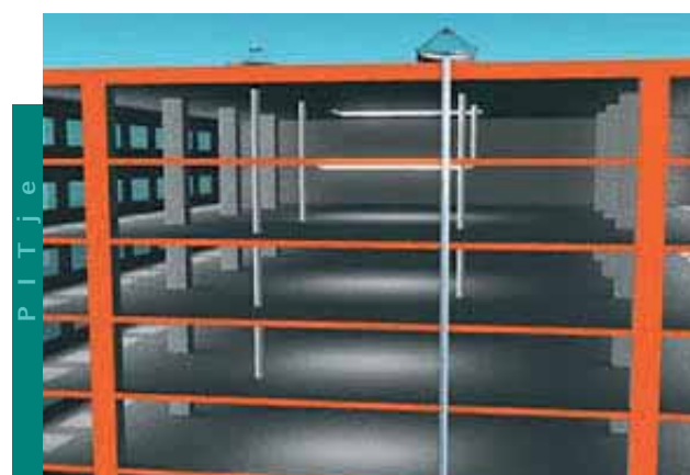
Zonlicht door een pijp De zonlichtpijp is een holle pijp waarmee zonlicht dieper in een gebouw kan worden gebracht. Dit zorgt voor een prettiger lichtklimaat.
